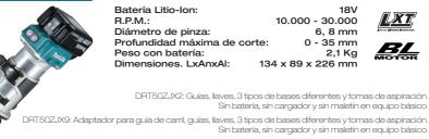
Batería Litio-lon: 18V R.P.M.: 10,000 - 30,000 Diámetro de pinza: 6.8 mm
