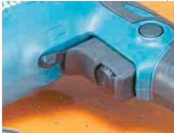
Gatillo con velocidad variable mediante dial
